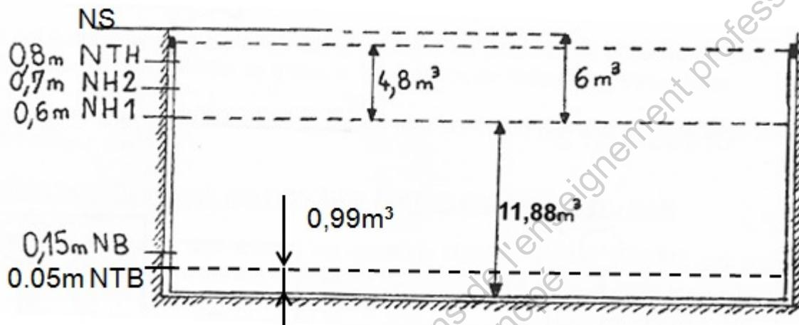
Les puisards équipés de deux pompes sont munis de seuils de niveaux ou de relais à seuils sur une mesure analogique délivrant les informations suivantes :
