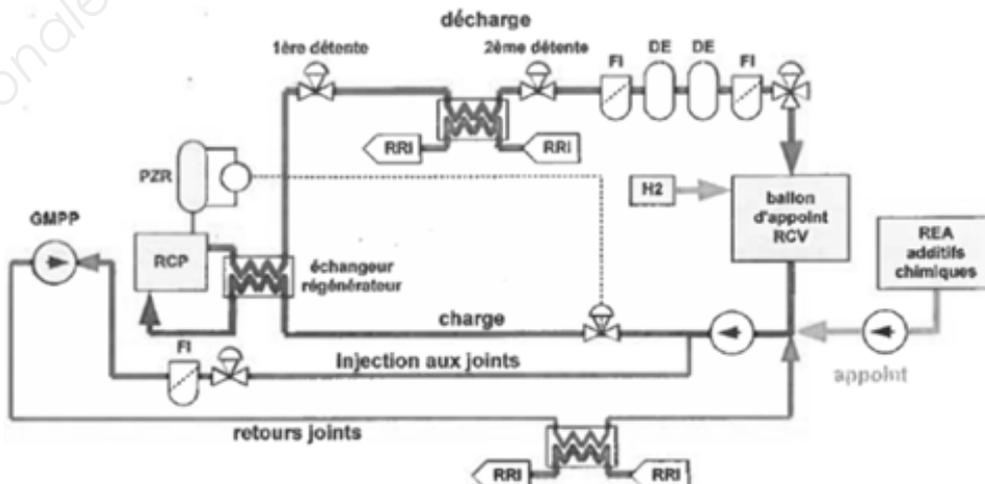
Pendant les transitoires d'arrêt ou de redémarrage du réacteur, la modulation de la teneur en bore est un des moyens essentiels dont on dispose pour contrôler la réactivité.
