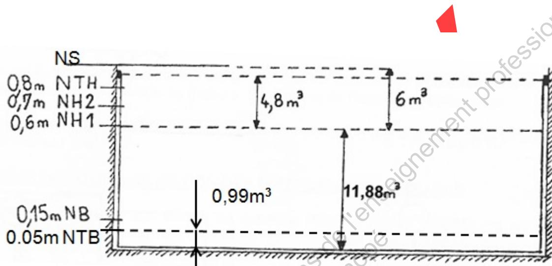
Les puisards équipés de deux pompes sont munis de seuils de niveaux ou de relais à seuils sur une mesure analogique délivrant les informations suivantes :
