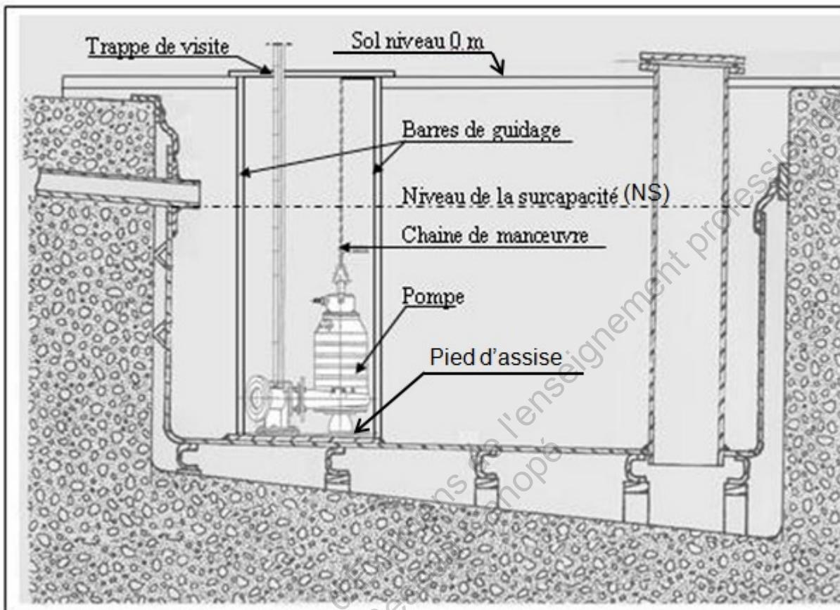
**Barres de guidage** : servent à guider la descente de la pompe pour son raccordement au pied d'assise.
